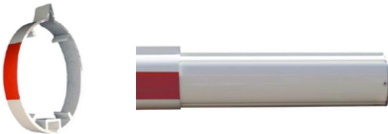
Profilé extrudé 102 x 82 mm • Extrêmement robuste - Testé avec barrière d'accès 4 M chargée à 600 kg en partie centrale • Equipé en partie supérieure avec une protection anti-assise de 13 mm et en partie inférieure avec une rainure pour vis avec une clé d'ajustage • Stabilisation supplémentaire par câble de tension à partir de 5,5 M • Laquage ÉPOXY de haute qualité en RAL 9010 HR (blanc semi mat) • Avec plusieurs bandes réflectos rouges de 0,5 m 3MTM
