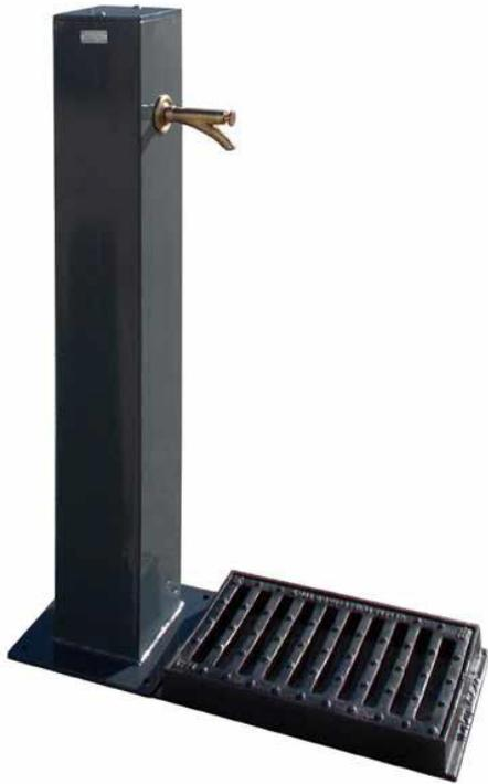
Fontaine Trieste est constituée par une structure en tubulaire d'acier quadre 150x150mm ép.4mm, fermée en haut par un couvercle en acier 150x150 fixé par deux vis à pouvoir être enlevé facilement pour les opérations de l'installation et l'entretien du robinet.
